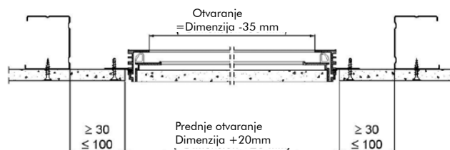
Shematski prikaz: revizijska vrata sa zaštitom od prskanja vode
